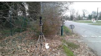
Appareillage : sonomètre FUSION 01dB de Classe 1 (n° de série : 11277) - Calibreur ACLAN CAL 01
