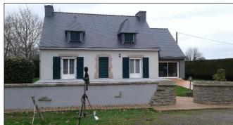
Appareillage : sonomètre FUSION 01dB de Classe 1 (n° de série : 10312) - Calibreur ACLAN CAL 01
