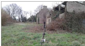
Appareillage : sonomètre FUSION 01dB de Classe 1 (n° de série : 11299) - Calibreur ACLAN CAL 01
