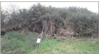
Appareillage : sonomètre FUSION 01dB de Classe 1 (n° de série : 11332) - Calibreur ACLAN CAL 01
