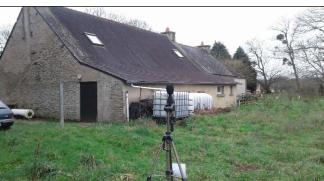
Appareillage : sonomètre FUSION 01dB de Classe 1 (n° de série : 10313) - Calibreur ACLAN CAL 01
